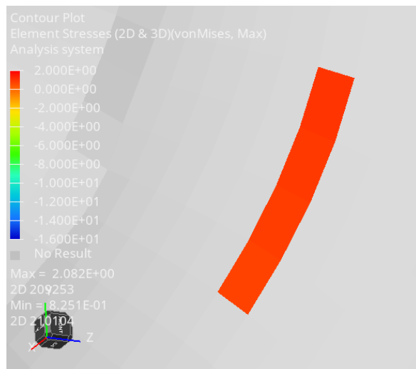
Figura 13. Valor de máxima tensão \sigma_{1.0t} a distância de 1.0t (2.082 MPa) na ponta da região soldada (utilizada para extrapolação conforme a norma IIW). Fonte: Autor.
